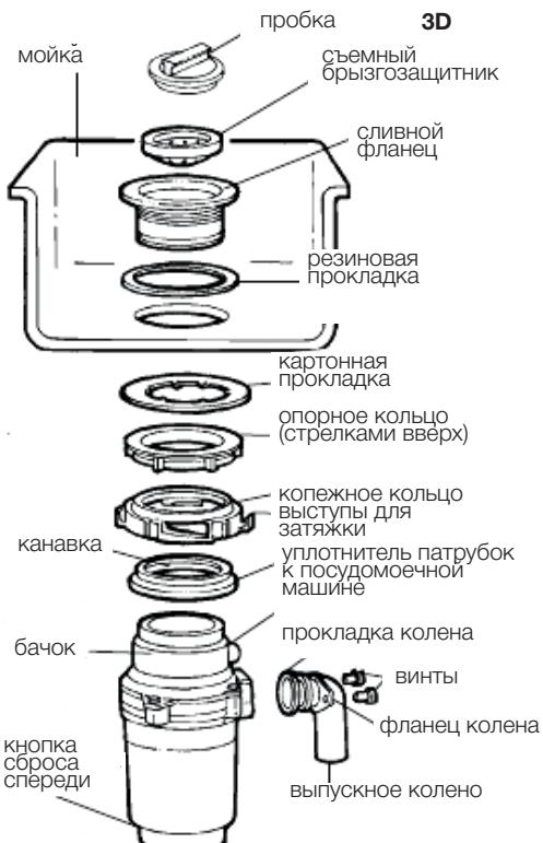
**И.** Измельчитель устанавливается так, чтобы кнопка сброса была легко доступна.
